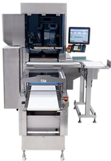
Confezionatrice automatica che fornisce la soluzione completa di confezionamento ed etichettatura nella linea di produzione contribuendo a ridurre al minimo i tempi di inattività. Ingresso del vassoio automatico, pesatura, confezionamento ed etichettatura in una unica soluzione compatta. La direzione di uscita modificabile permette di adattarsi a tutte le tipologie di linee di produzione.
